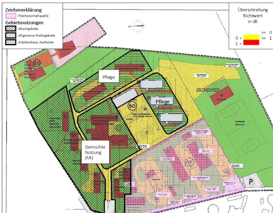
**Abb. 11: Gebietsnutzung nach B-Plan (Plan + Text)- Richtwertüberschreitung bei maximal zulässiger Schallemission durch Gewerbegebiet**
