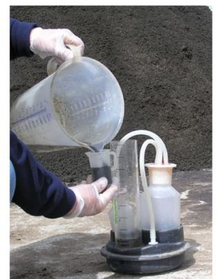
Bild 2: Quantofixgerät
