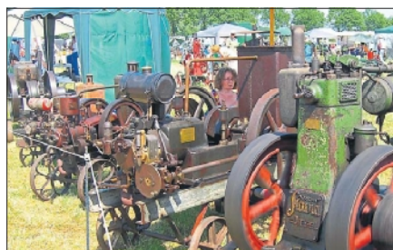
Eine besondere Motorenschau organisiert die »Interessengemeinschaft Historische Motoren Deutschland« (IG-HM) an diesem Wochenende am Traktorenmuseum »Glitz«. Zu sehen sind mehr als 100 historische Maschinen wie etwa diese rund 90 Jahre alte dieselgetriebene Lokomobile, die zum Betrieb von Dreschkästen, Kreissägen oder Pumpen im Einsatz war.
