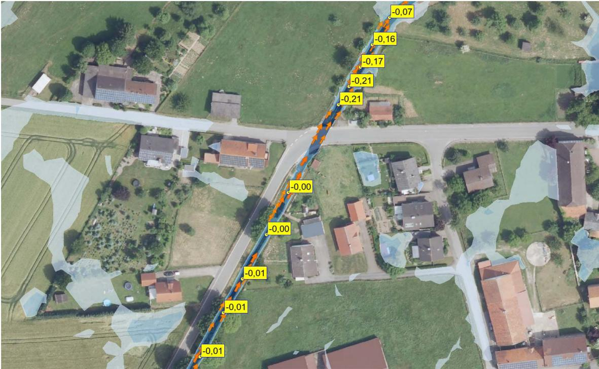
Abbildung 32: Wasserspiegeldifferenz Planungszustand minus Istzustand, Aufweitung Wassergraben Szenario 1
