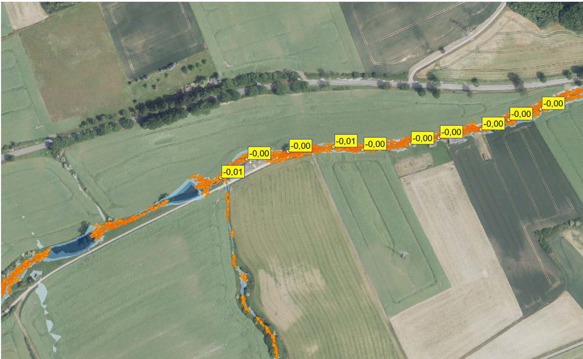
Abbildung 31: Wasserspiegeldifferenz Planungszustand minus Istzustand, Becken Wassergraben Szenario 1
